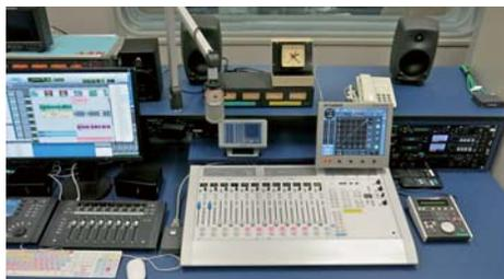
OnAir シリーズは、ワンマンでの生放送にも標準仕様にて対応しているため、アナウンサーが音声卓を操作しながらコメントを収録できるよう、ワンマン運用にも対応できるシステムも採り入れることになりました。もちろんアナウンスブースにもカフを2式用意し、従来のツーマンの運用スタイルも継承しています。また音声システム更新工事の際、既存の映像編集室との回線も布
