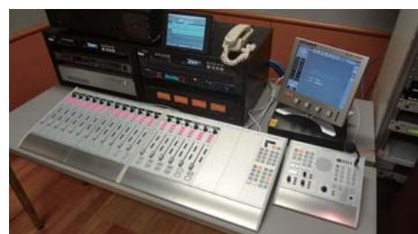
他社の卓にもそれぞれ長所はありましたが、ミキサー陣からの意見でロータリーエンコーダーの反応が最も実際の運用に適しているスチューダー製品の上位機種で再検討しました。必要とする音声入出力、GPIO 数を考慮するとOnAir 3000が最適でしたが、当然OnAir 1500で検討していた際の費用とはかけ離れてしまいます。
