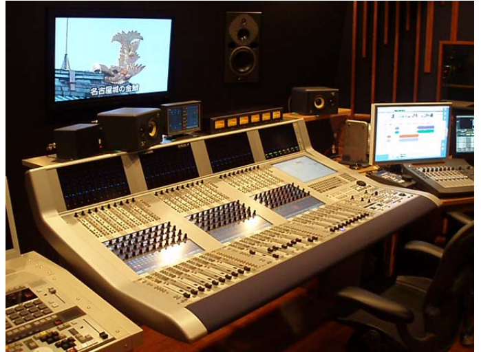
■マシンコントロールを考慮し卓のセンターをオフセット
